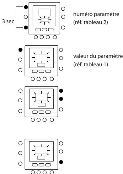
Tous les paramètres peuvent être programmés en utilisant la même procédure. Une fois terminée, appuyer sur OK pour sauvegarder les paramètres et la page-écran normale sera affichée (Si la page-écran courante montre le numéro du paramètre).
